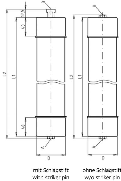
**Beidseitiges Innengewinde / Both ends female thread****Ohne Schlagstift / Without striker pin****Mit Schlagstift / With striker pin****Einsatz / Application****Einbau in den Öl-Transformer / Oil-transformer application****Verpackung / Packing 1 Stück / 1 piece**
